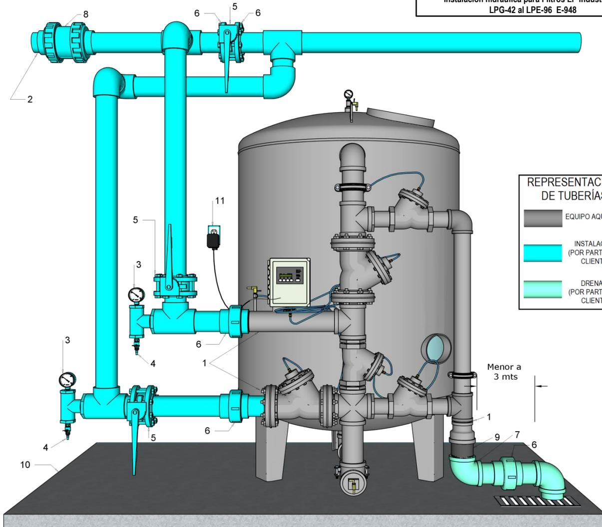
1. Respetar el diámetro de entrada, salida y drenaje marcados por el arnés de válvulas.
